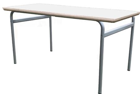
Mesa de adulto extensible, compuesta por estructura de tubo metálico de Ø32x1,5 mm (Ø28x1,5 mm tubo interior), con perfiles laterales de 50x25x1,5 mm y por tapa en tablero MDF laminado de 21 mm de espesor con cantos redondeados y superficie y contratiro de laminado de alta presión (HPL).
