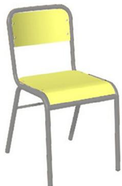
Silla infantil, compuesta por estructura de tubo metálico de Ø25x1,5 mm y por dos piezas de madera contrachapada curvada de 10 mm de espesor, con superficie y contratiro de laminado de alta presión (HPL) con cantos redondeados.
