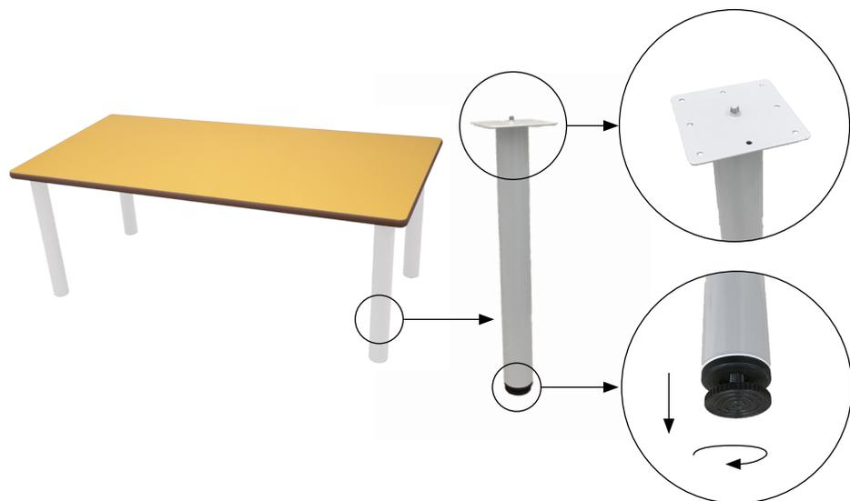
Mesa infantil rectangular, compuesta por cuatro patas de tubo metálico de Ø50 x 1,5 mm con acabado en pintura Epoxi y una tapa tablero MDF laminado de 21 mm de espesor, con cantos redondeados y superficie y contratiro de laminado de alta presión (HPL). Incorpora conteras niveladoras para evitar que cojee. Íntegramente desmontable, reduciendo así el impacto ambiental en su transporte.
