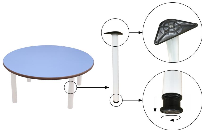
Mesa de adulto redonda, compuesta por cuatro patas de tubo metálico de Ø60 x 1,5 mm con acabado en pintura Epoxi y una tapa en tablero MDF laminado de 21 mm de espesor, con cantos redondeados y superficie y contratiro de laminado de alta presión (HPL). Incorpora conteras niveladoras para evitar que cojee. Acabado de estructura en pintura Epoxi. Íntegramente desmontable, reduciendo así el impacto ambiental en su transporte.
