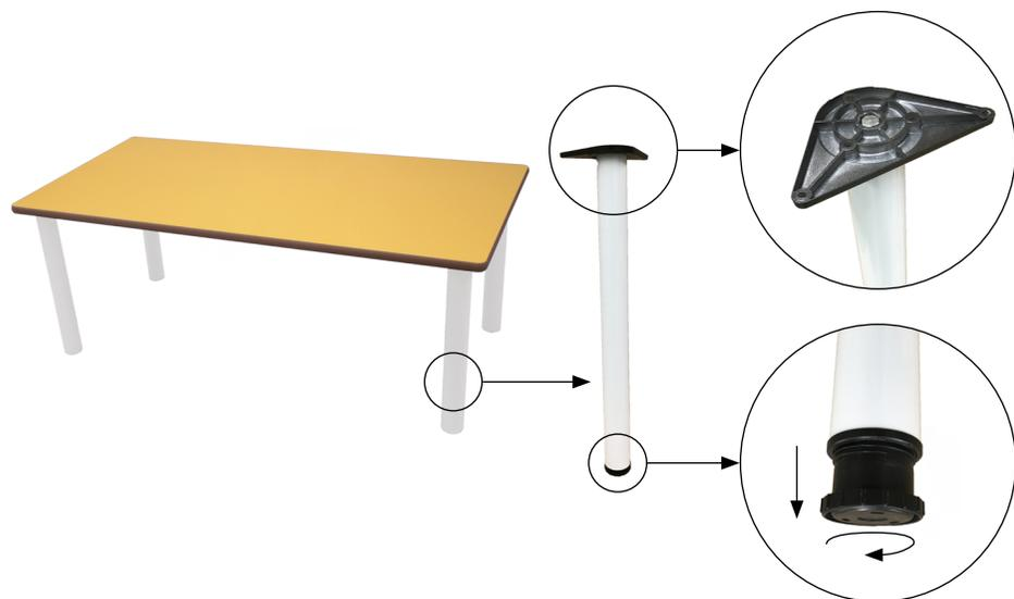
Mesa de adulto rectangular, compuesta por cuatro patas de tubo metálico de  $\text{Ø}60 \times 1,5$  mm con acabado en pintura Epoxi y una tapa en tablero MDF laminado de 21 mm de espesor, con cantos redondeados y superficie y contratiro de laminado de alta presión (HPL). Incorpora conteras niveladoras para evitar que cojee. Acabado de estructura en pintura Epoxi. Íntegramente desmontable, reduciendo así el impacto ambiental en su transporte.
