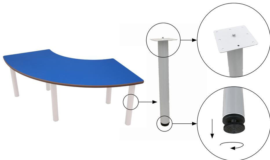
Mesa infantil 1/4 de aro, compuesta por cuatro patas de tubo metálico de Ø50 x 1,5 mm con acabado en pintura Epoxi y una tapa en tablero MDF laminado de 21 mm de espesor, con cantos redondeados y superficie y contra-tiro de laminado de alta presión (HPL).
