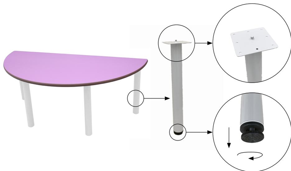
Mesa infantil semiredonda, compuesta por cuatro patas de tubo metálico de Ø50 x 1,5 mm con acabado en pintura Epoxi y una tapa en tablero MDF laminado de 21 mm de espesor, con cantos redondeados y superficie y contratiro de laminado de alta presión (HPL). Incorpora conteras niveladoras para evitar que cojee. Íntegramente desmontable, reduciendo así el impacto ambiental en su transporte.
