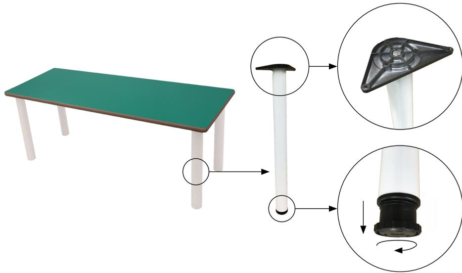
Mesa ala de adulto rectangular, compuesta por cuatro patas de tubo metálico de Ø60 x 1,5 mm con acabado en pintura Epoxi y una tapa en tablero MDF laminado de 21 mm de espesor, con cantos redondeados y superficie y contratiro de laminado de alta presión (HPL). Incorpora conteras niveladoras para evitar que cojee. Acabado de estructura en pintura Epoxi. Íntegramente desmontable, reduciendo así el impacto ambiental en su transporte.
