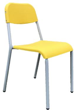
Silla escolar, compuesta por una estructura metálica de tubo de Ø25x1,5 mm y asiento y respaldo en polipropileno de 5 mm de espesor y acabado liso mate. Incorpora conteras de goma en la base de las patas para reducir el deslizamiento, la vibración y el ruido. Apilables para aprovechar el espacio y reducir el impacto ambiental en su transporte. Acabado de la estructura en pintura Epoxi.
