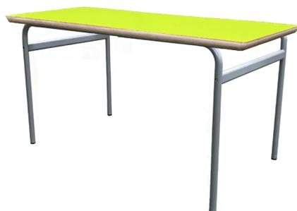
Mesa infantil extensible, compuesta por estructura de tubo metálico de Ø32x1,5 mm (Ø28x1,5 mm tubo interior), con perfiles laterales de 50x25x1,5 mm y por tapa en tablero MDF laminado de 21 mm de espesor con cantos redondeados y superficie y contratiro de laminado de alta presión (HPL).
