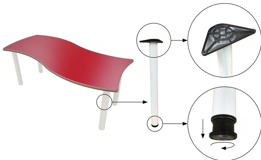
Mesa de adulto rectangular ONDA, compuesta por cuatro patas de tubo metálico de Ø60 x 1,5 mm con acabado en pintura Epoxi y una tapa en tablero MDF laminado de 21 mm de espesor, con cantos redondeados y superficie y contratiro de laminado de alta presión (HPL).
