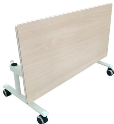
Mesa infantil abatible lateral, incluye cuatro ruedas con sistema de freno. Compuesta por una tapa en tablero MDF laminado de 21 mm de espesor con cantos redondeados y superficie y contratiro de laminado de alta presión (HPL), y por estructura de tubo metálico, montantes y travesaño de sección 50x25x1,5 mm y patas de sección circular Ø38x1,5 mm.
