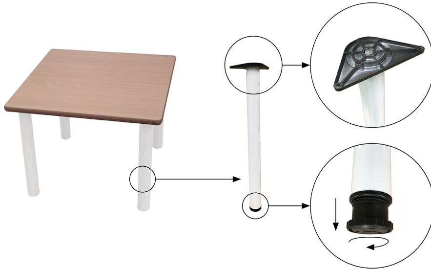
Mesa de adulto cuadrada, compuesta por cuatro patas de tubo metálico de Ø60 x 1,5 mm con acabado en pintura Epoxi y una tapa en tablero MDF laminado de 21 mm de espesor, con cantos redondeados y superficie y contratiro de laminado de alta presión (HPL). Incorpora conteras niveladoras para evitar que cojee. Acabado de estructura en pintura Epoxi. Íntegramente desmontable, reduciendo así el impacto ambiental en su transporte.
