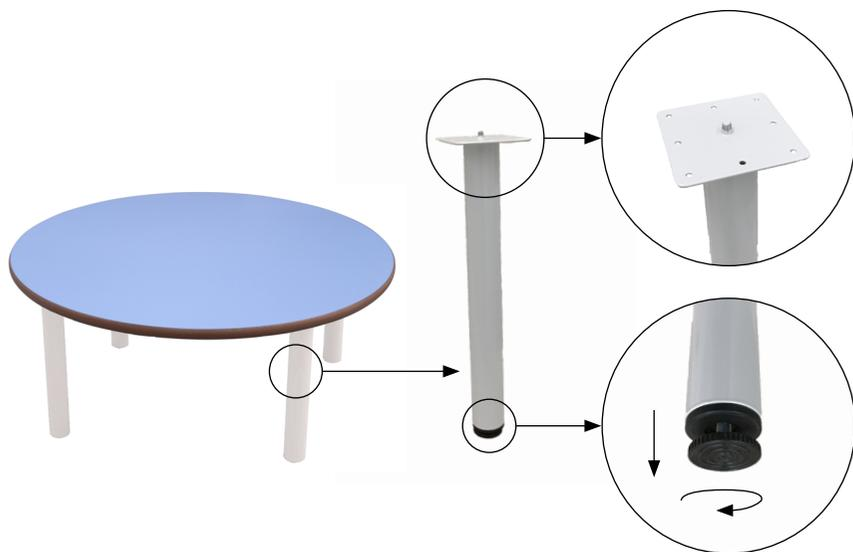
Mesa infantil redonda, compuesta por cuatro patas de tubo metálico de  $\text{Ø}50 \times 1,5 \text{ mm}$  con acabado en pintura Epoxi y una tapa en tablero MDF laminado de 21 mm de espesor, con cantos redondeados y superficie y contra-tiro de laminado de alta presión (HPL).
