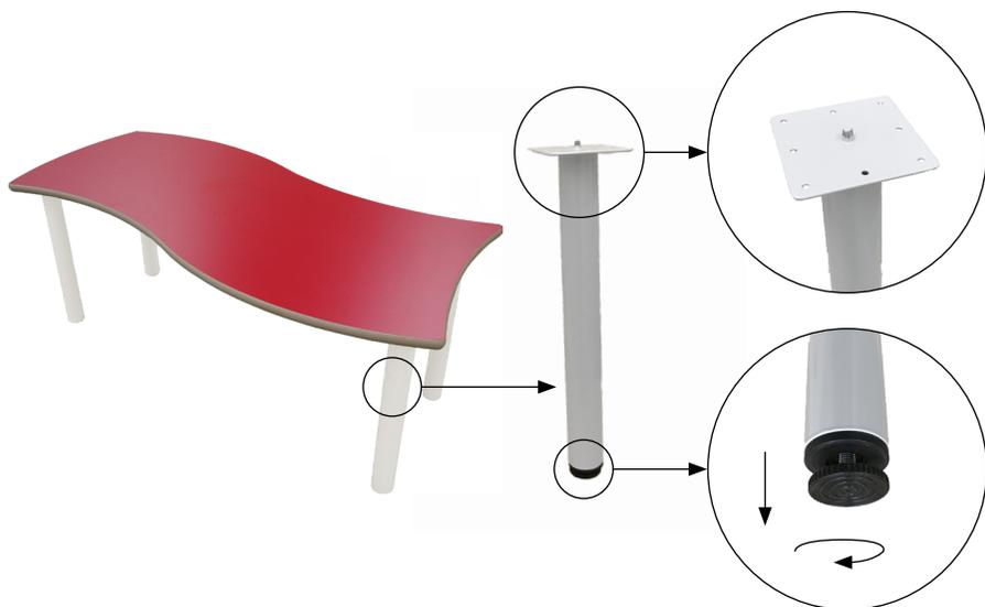
Mesa infantil rectangular ONDA, compuesta por cuatro patas de tubo metálico de Ø50 x 1,5 mm con acabado en pintura Epoxi y una tapa en tablero MDF laminado de 21 mm de espesor, con cantos redondeados y superficie y contratiro de laminado de alta presión (HPL). Incorpora conteras niveladoras para evitar que cojee. Íntegramente desmontable, reduciendo así el impacto ambiental en su transporte.
