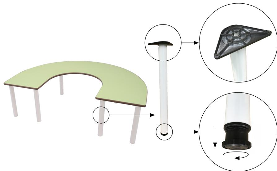
Mesa de adulto en forma de U, compuesta por seis patas de tubo metálico de Ø60 x 1,5 mm con acabado en pintura Epoxi y una tapa en tablero MDF laminado de 21 mm de espesor, con cantos redondeados y superficie y contratiro de laminado de alta presión (HPL). Incorpora conteras niveladoras para evitar que cojee. Acabado de estructura en pintura Epoxi. Íntegramente desmontable, reduciendo así el impacto ambiental en su transporte.
