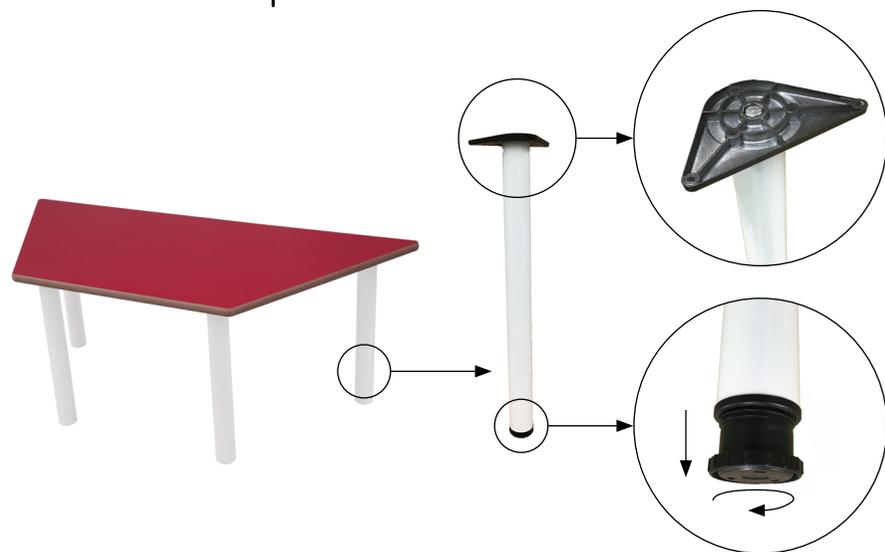
Mesa de adulto trapezoidal, compuesta por cuatro patas de tubo metálico de Ø60 x 1,5 mm con acabado en pintura Epoxi y una tapa en tablero MDF laminado de 21 mm de espesor, con cantos redondeados y superficie y contratiro de laminado de alta presión (HPL). Incorpora conteras niveladoras para evitar que cojee. Acabado de estructura en pintura Epoxi. Íntegramente desmontable, reduciendo así el impacto ambiental en su transporte.
