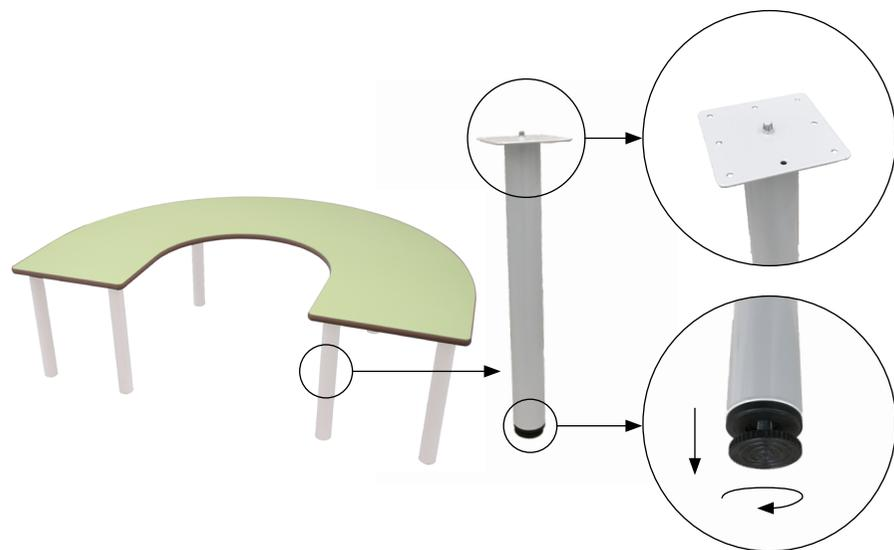
Mesa infantil en forma de U, compuesta por seis patas de tubo metálico de Ø50 x 1,5 mm con acabado en pintura Epoxi y una tapa en tablero MDF laminado de 21 mm de espesor, con cantos redondeados y superficie y contratiro de laminado de alta presión (HPL). Incorpora conteras niveladoras para evitar que cojee. Íntegramente desmontable, reduciendo así el impacto ambiental en su transporte.
