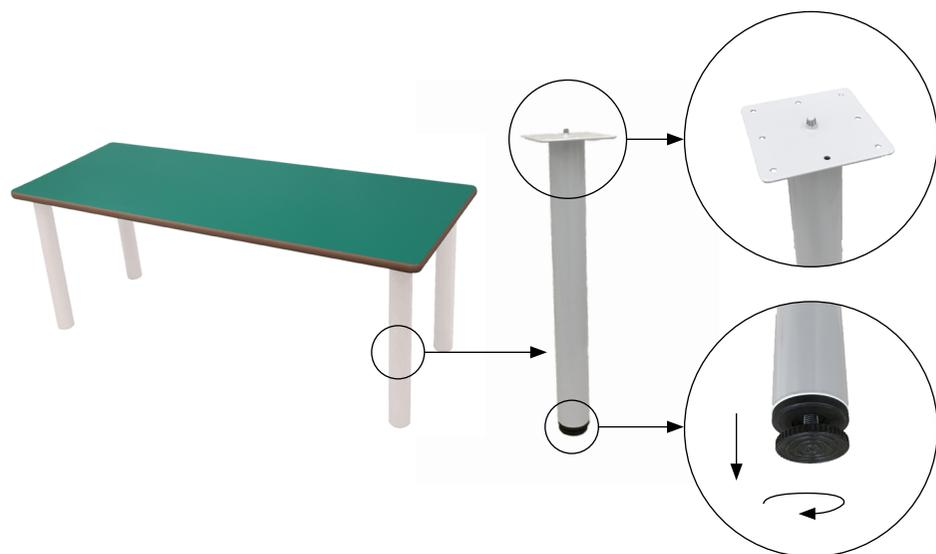
Mesa ala infantil rectangular, compuesta por cuatro patas de tubo metálico de Ø50 x 1,5 mm con acabado en pintura Epoxi y una tapa en tablero MDF laminado de 21 mm de espesor, con cantos redondeados y superficie y contratiro de laminado de alta presión (HPL). Incorpora conteras niveladoras para evitar que cojee. Íntegramente desmontable, reduciendo así el impacto ambiental en su transporte.
