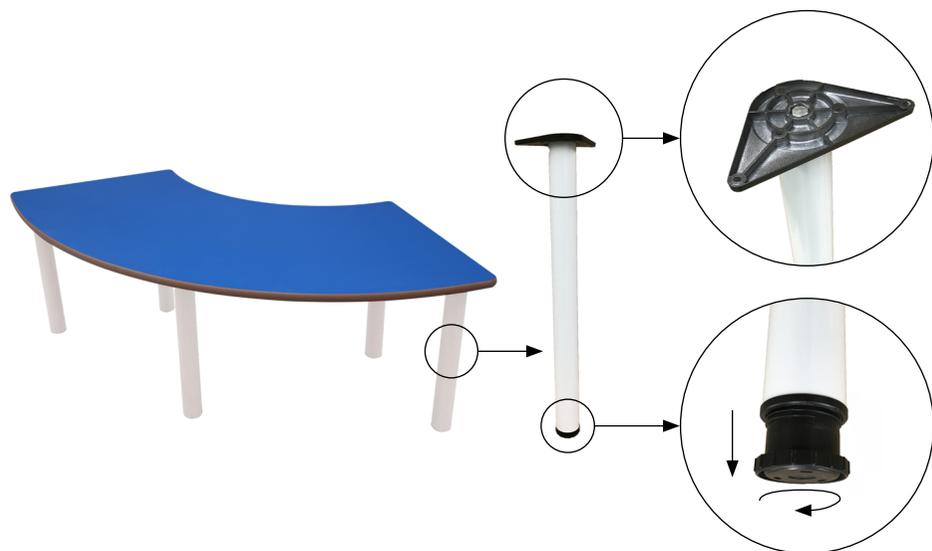
Mesa de adulto 1/4 de aro, compuesta por cinco patas de tubo metálico de Ø60 x 1,5 mm con acabado en pintura Epoxi y una tapa en tablero MDF laminado de 21 mm de espesor, con cantos redondeados y superficie y contratiro de laminado de alta presión (HPL). Incorpora conteras niveladoras para evitar que cojee. Acabado de estructura en pintura Epoxi. Íntegramente desmontable, reduciendo así el impacto ambiental en su transporte.
