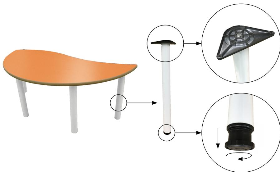
Mesa de adulto semiredonda ONDA, compuesta por cuatro patas de tubo metálico de  $\text{Ø}60 \times 1,5$  mm con acabado en pintura Epoxi y una tapa en tablero MDF laminado de 21 mm de espesor, con cantos redondeados y superficie y contratiro de laminado de alta presión (HPL).
