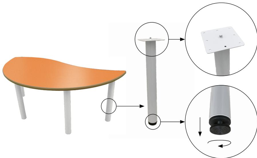
Mesa infantil semiredonda ONDA, compuesta por cuatro patas de tubo metálico de Ø50 x 1,5 mm con acabado en pintura Epoxi y una tapa en tablero MDF laminado de 21 mm de espesor, con cantos redondeados y superficie y contratiro de laminado de alta presión (HPL). Incorpora conteras niveladoras para evitar que cojee. Íntegramente desmontable, reduciendo así el impacto ambiental en su transporte.
