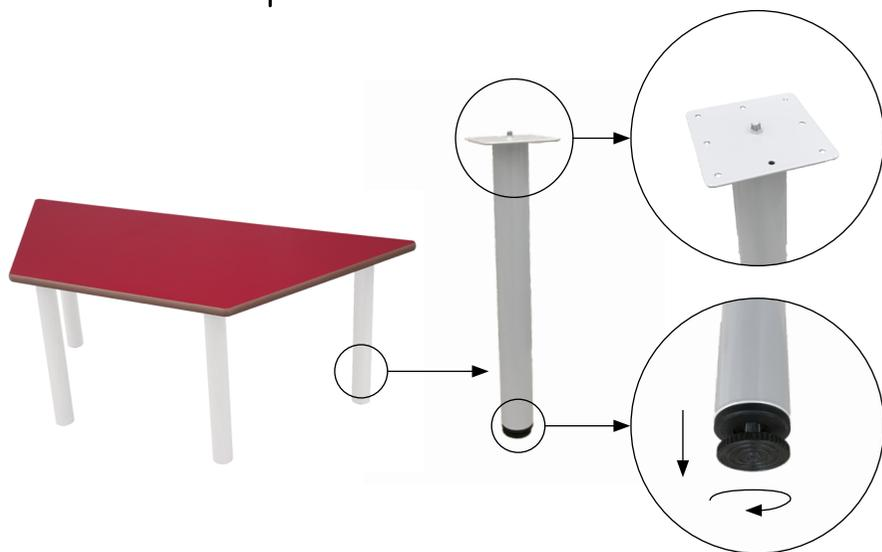
Mesa infantil trapezoidal, compuesta por cuatro patas de tubo metálico de Ø50 x 1,5 mm con acabado en pintura Epoxi y una tapa en tablero MDF laminado de 21 mm de espesor, con cantos redondeados y superficie y contratiro de laminado de alta presión (HPL). Incorpora conteras niveladoras para evitar que cojee. Íntegramente desmontable, reduciendo así el impacto ambiental en su transporte.
