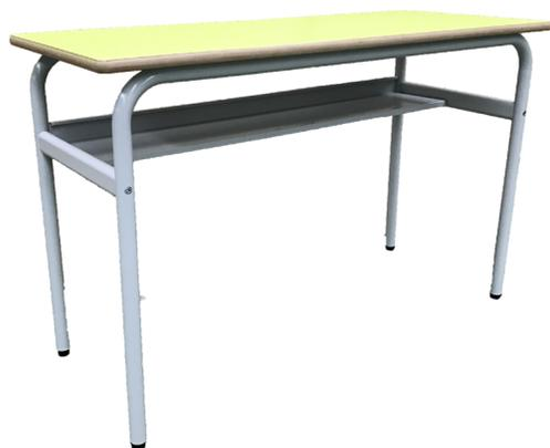
Pupitre doble fijo. Compuesto por estructura de tubo metálico de Ø32x1,5 mm y una tapa en tablero MDF laminado de 21 mm de espesor, con superficie y contra-tiro en laminado de alta presión (HPL) y con cantos redondeados.
