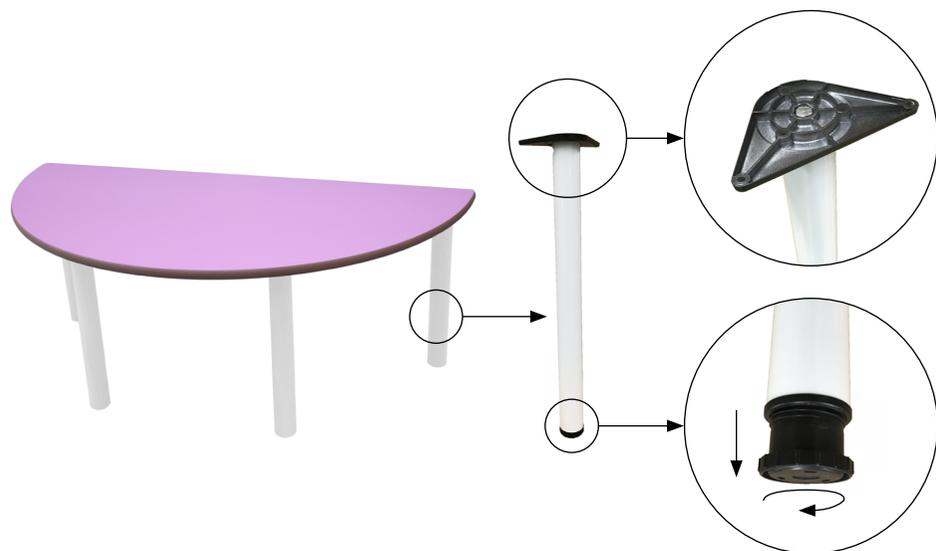
Mesa de adulto semiredonda, compuesta por cuatro patas de tubo metálico de Ø60 x 1,5 mm con acabado en pintura Epoxi y una tapa en tablero MDF laminado de 21 mm de espesor, con cantos redondeados y superficie y contratiro de laminado de alta presión (HPL). Incorpora conteras niveladoras para evitar que cojee. Acabado de estructura en pintura Epoxi. Íntegramente desmontable, reduciendo así el impacto ambiental en su transporte.
